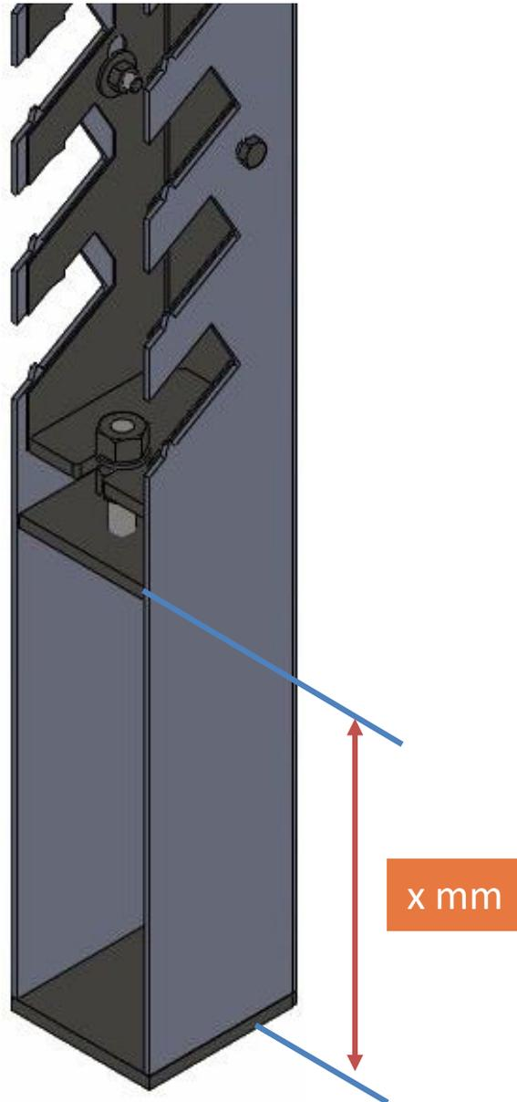
Pfosten mit Bodeneinstand BEIST «x mm»
